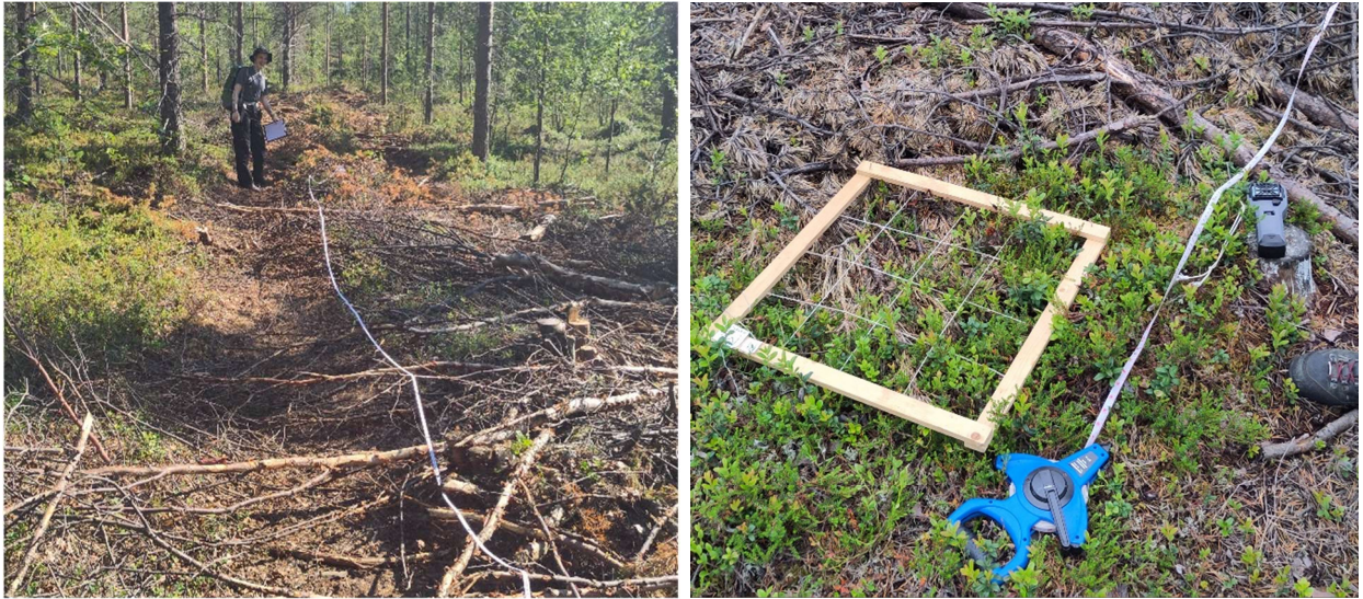
Figur 3: (t.v) 10m målebånd blir lagt ut for å sette avstanden mellom målestasjonene. (t.h.) Feltrute er lagt ned ved enden av 10m målebånd, slik at posisjonen til ruta blir tilfeldig plassert.
